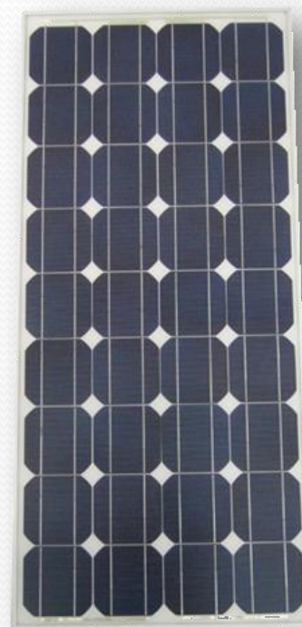
Фотоэлектрический модуль с планарными СЭ электрической мощностью 60 Вт. Размеры 1200×540 мм, 36 солнечных элементов
